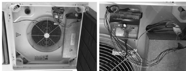
Figura 5. Instalação do atuador no espaço interno do aparelho de ar condicionado.
