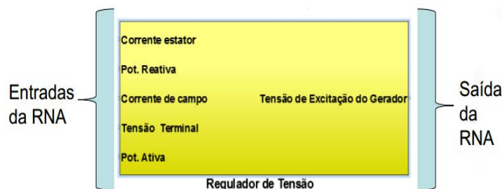
Figura 2 – Estrutura da rede neural usada para excitação do gerador
